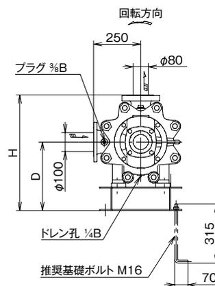
注) 全長寸法、概算質量及び端子箱位置は、電動機メーカーにより異なることがあります。
